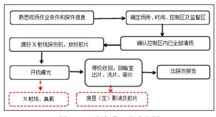
图 2-7 现场探伤工艺流程图
