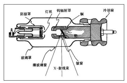
图 2-1 典型的 X 射线管结构图
