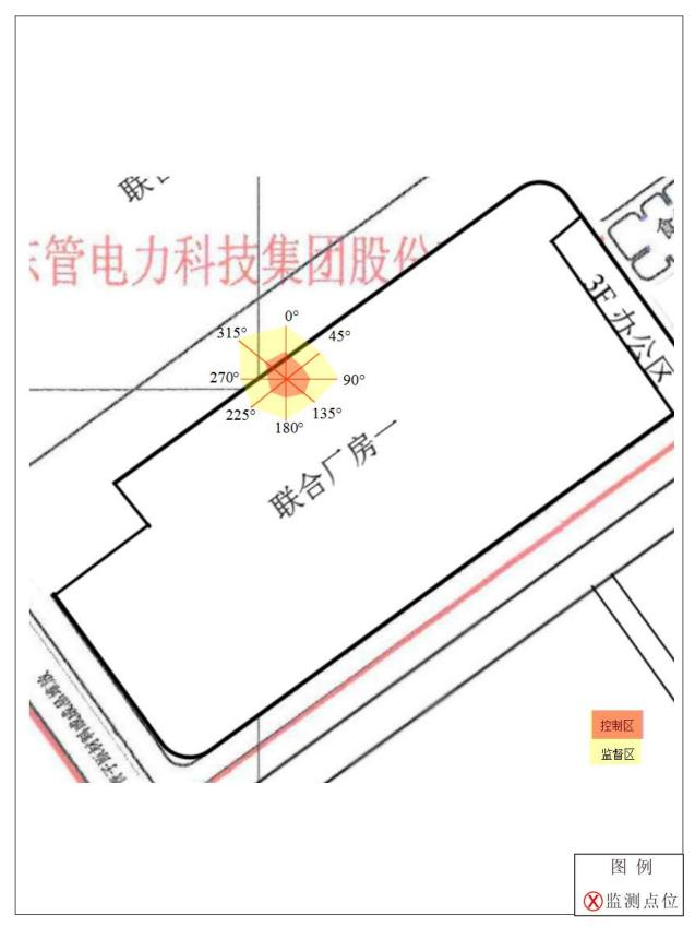
附图六 XXG2005D 型 X 射线探伤机现场探伤监测示意图
